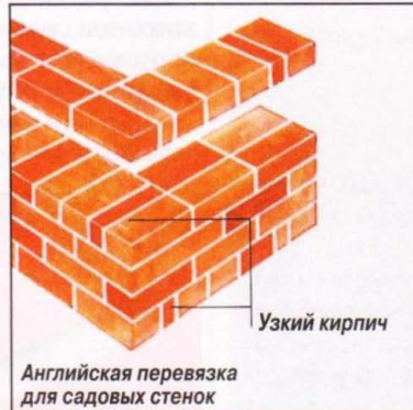
Рис. З. Здесь в отличие от обычной английской перевязки три или пять ложковых рядов чередуются с одним тычковым.
