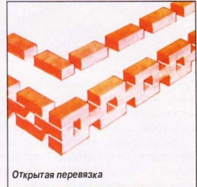
Рис. К. При открытых видах перевязки кирпичи смежных рядов перекрывают друг друга на 1/3-1/4 длины кирпича, образуя таким образом ажурную кладку.
